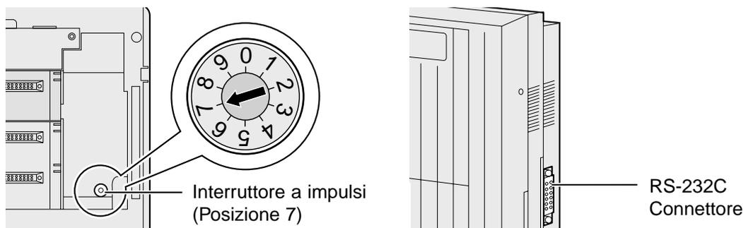
3. Collegare un PC con un software di comunicazione al connettore RS-232C (figura seguente) mediante un cavo modem Null. Impostare i parametri di comunicazione sui valori seguenti.
