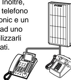
1.4.1 Aggiunta di un altro telefono in parallelo
